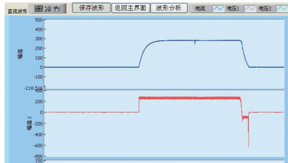
时间常数为15ms时，断路器分断电流波形图
